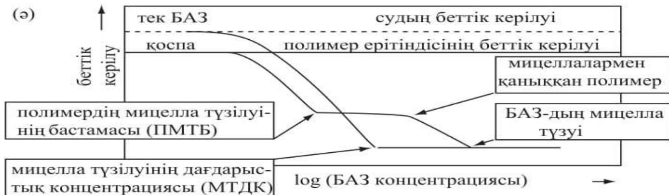
4-сурет. а – беттік керілудің әртүрлі концентрациядағы БАЗ ерітінділеріне енгізілген, поливинилпирролидонның қатысындағы натрий додецилсульфатының концентрациясына тәуелділігі.
